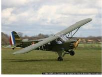
Le Piper L-4 est un avion de brousse par excellence ! Version militaire du célèbre Piper Cub, il est particulièrement apprécié pour ses qualités de vol. Conçu dans les années 1930, il est motorisé par un 4 Cylindres à plat Continental A-65 de 65 CV. Sa robustesse, sa facilité d'entretien lui permettent de traverser le temps sans difficulté. Décollant sur une distance de 245 m et pouvant atterrir sur une distance de 200m, il possède les qualités d'un véritable avion de brousse.
